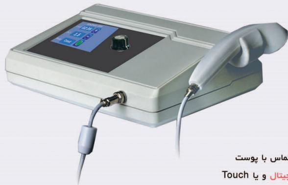
اولتراسوند با پروب  $7\text{cm}^2$  و فرکانس 1MHz
